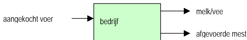
Figuur 5. Schematische weergave van de bedrijfsbalans als instrument voor het realiseren van fosfaatevenwichtbemesting (bodemoverschot = 0): P_2O_5 in aangekocht voer = P_2O_5 in melk/vee + P_2O_5 in afgevoerde mest. Het gaat om de netto bedragen (voorbeeld: de post 'aangekochte voer' is het verschil tussen de werkelijke aankoop en de verkoop van voer)
